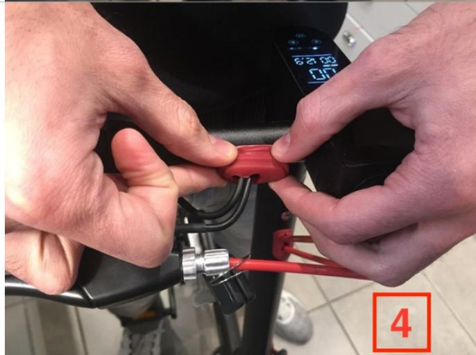
Etape 4 : Rangez les fils dans le tube du guidon et remplacez le cache (photo 4)
